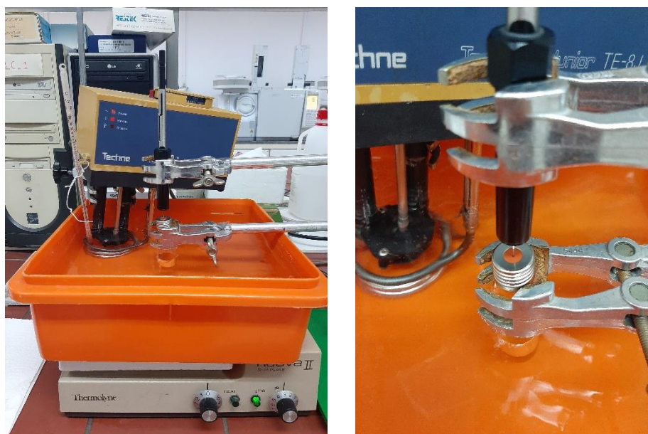
Εικόνα 7: Το δείγμα ελαιόλαδου με το μαγνητικό αναδευτήρα και την ίνα SPME στο υδατόλουτρο.
