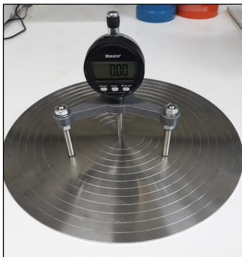
Εικόνα 7. Μέτρηση μονάδων Haugh (δίσκος και συσκευή).
