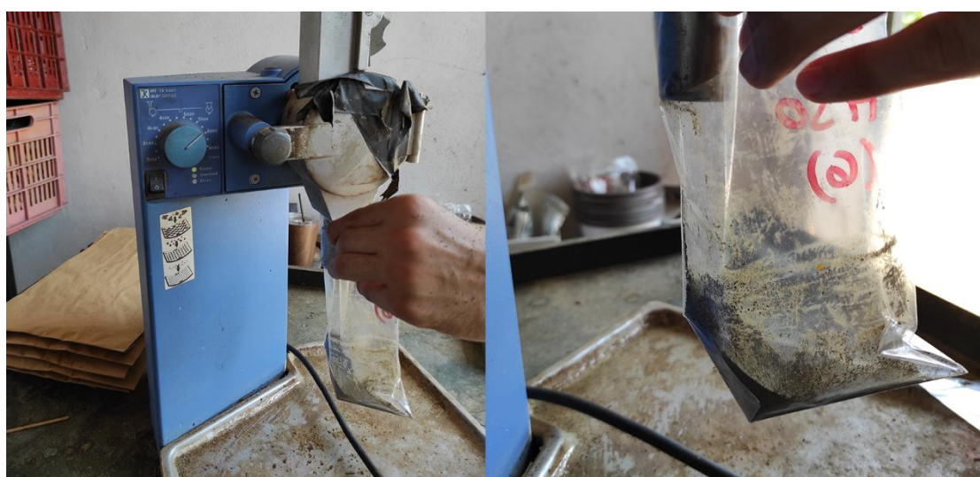
Εικόνα 20 Άλεση αποξηραμένου φυτικού ιστού με την χρήση του μύλου MF 10
