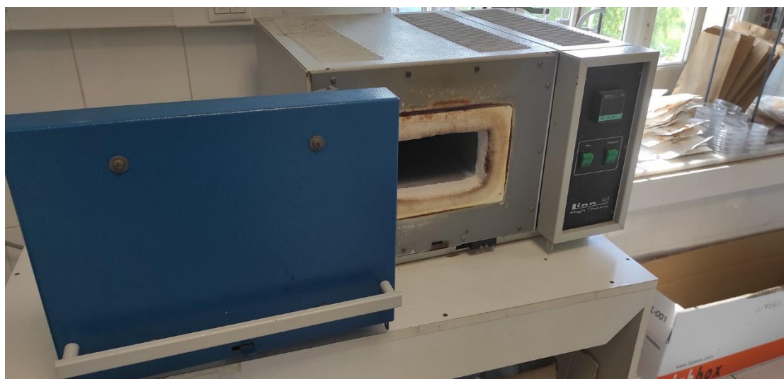
Εικόνα 21 Πυραντήριο LM-112 (Linn High Therm, Hirschbach, Germany)
