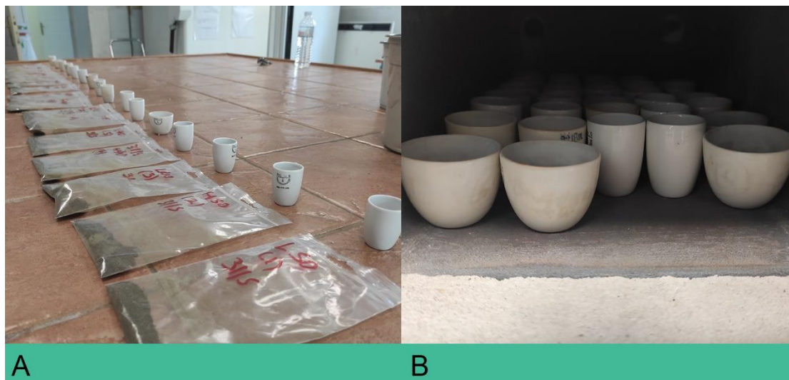
Εικόνα 22 Τοποθέτηση 0.5 g αλεσμένου δείγματος στις κάψες (A) και τοποθέτηση των καψών στο πυραντήριο (B)
