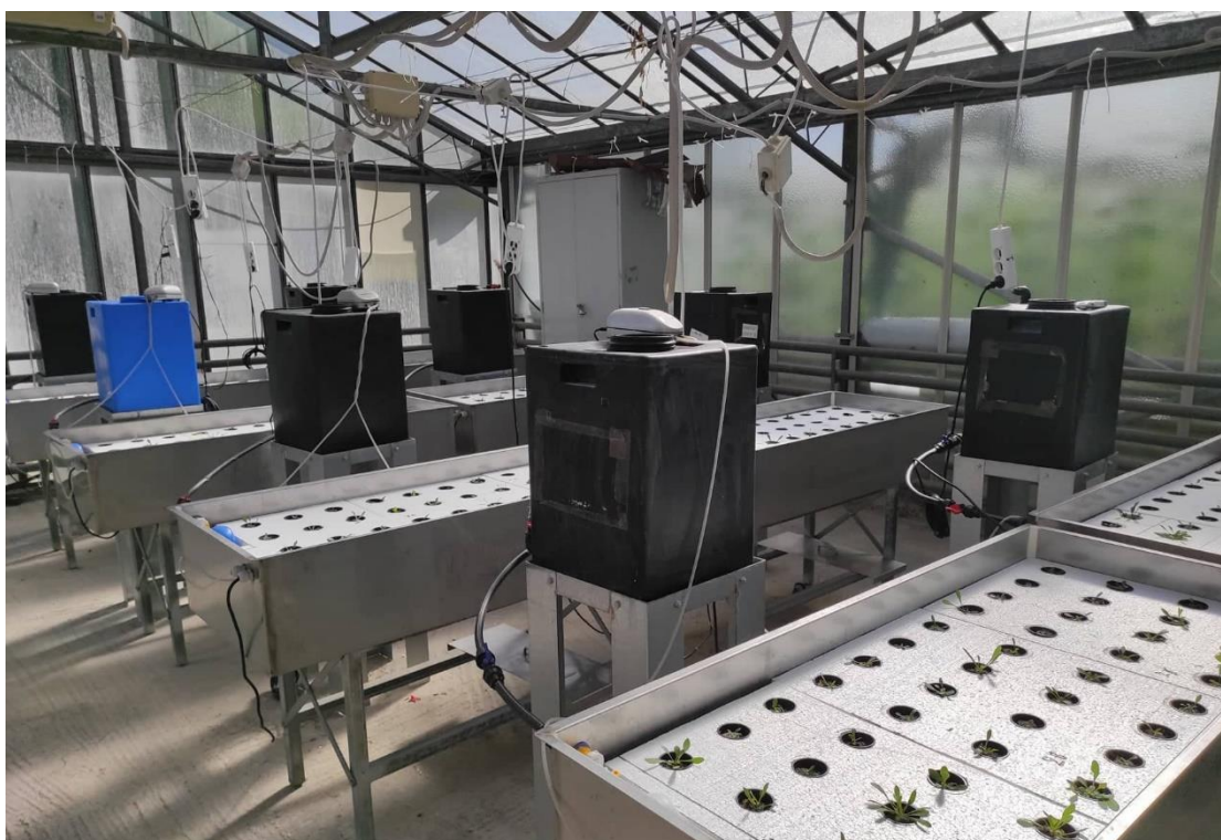
Εικόνα 18 Χώρος διεξαγωγής του πειράματος, με τα συστήματα επίπλευσης (λεκάνες με φελιζόλ που επιπλέουν στην επιφάνεια του θρεπτικού διαλύματος, και οι δεξαμενές παροχής θρεπτικού διαλύματος), μετά την μεταφύτευση των σποροφύτων
