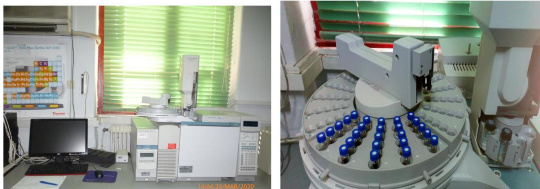
Εικόνα 76: Αέριος χρωματογράφος Agilent 6890 MS (αριστερά) με αυτόματο δειγματολήπτη 7683 (δεξιά), σε συνδυασμό με ανιχνευτή μάζας 5973 inert (GC/EI/MS).
