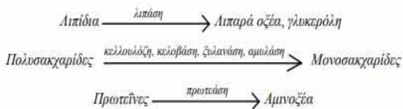
Εικόνα 8 Η σχηματική αναπαράσταση της διαδικασίας υδρόλυσης (Σιούλας, 2008)
