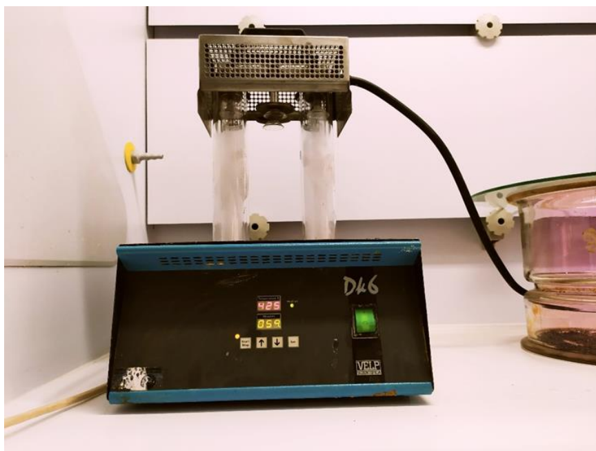
Εικόνα 8: Συσκευή υγρής καύσης (εφοδιασμένη με διάταξη απαγωγής αερίων) Velp Scientifica (Du6).
