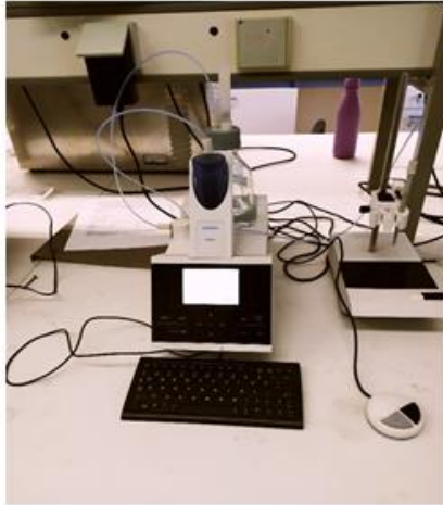
Εικόνα 16: Συσκευή τιτλοδότησης, εξουδετέρωση διαλύματος έως ότου αλλάξει το χρώμα του δείκτη
