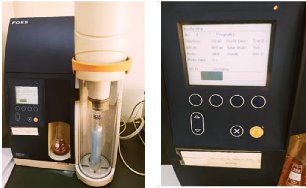
Εικόνα 9: Συσκευή απόσταξης Kjeldahl TM 8100 Distillation Unit, 220V/50Hz, με ρυθμιζόμενο πρόγραμμα.
