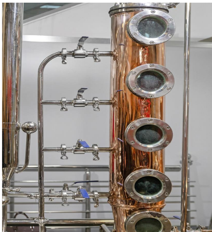
Εικόνα: 1.2.5.1.: Εξωτερική όψη στήλης παραδοσιακού αποστακτήρα
