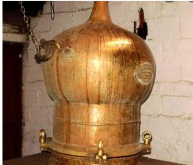
Εικόνα 1.2.3.: Κώδωνας ή καπέλο παραδοσιακής αποστακτικής συσκευής
