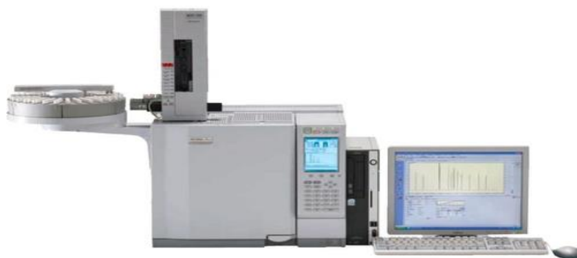
Εικόνα 1.9.1.2.: Απεικόνιση εξωτερικού συστήματος αέριας χρωματογραφίας
