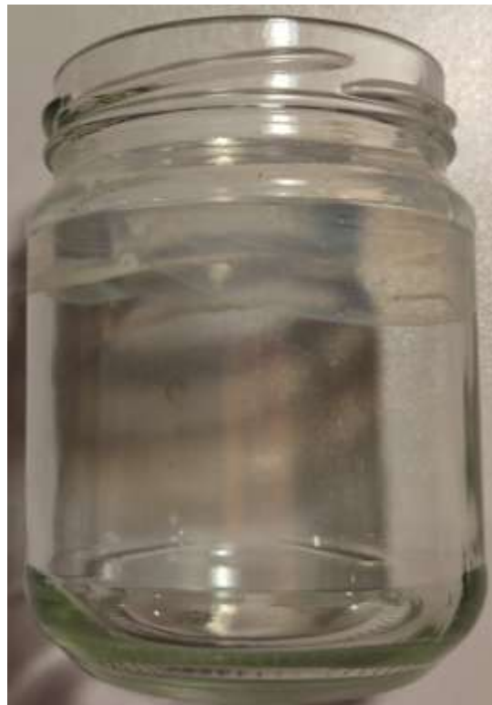
Εικ. 3.28 Φιαλίδιο βιοδοκιμών για το πείραμα του ανταγωνισμού με επίστρωση polytetrafluoroethylen.
