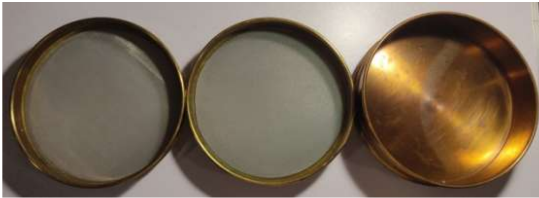
Εικ. 3.17 Κόσκινα για την απομόνωση των ωών O. surinamensis από το λευκό αλεύρι σίτου.
