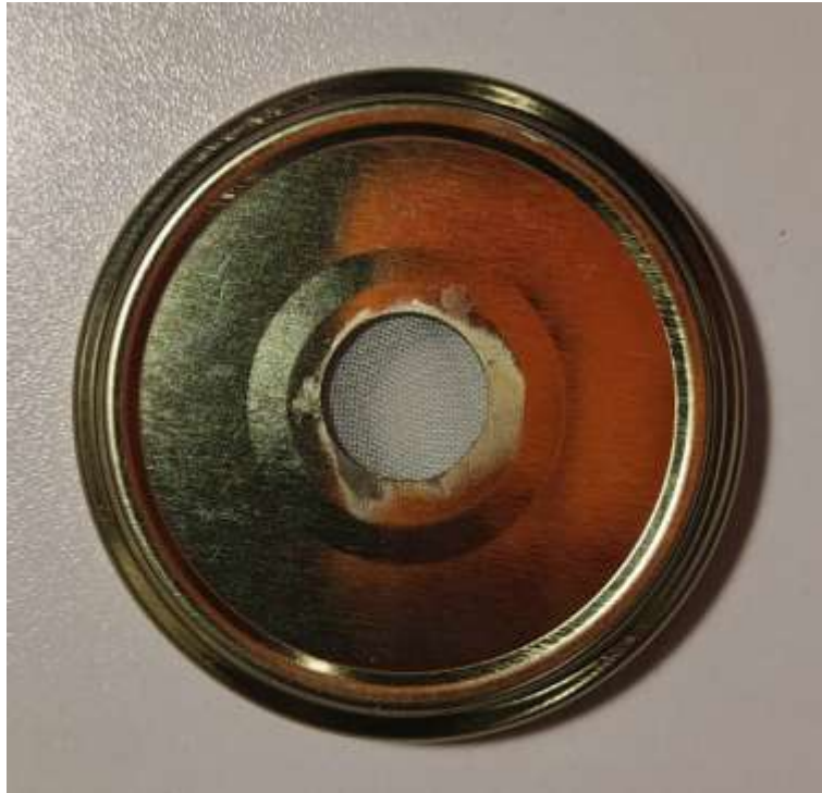
Εικ. 3.29 Καπάκι γυάλινων φιαλιδίων με κυκλική οπή κεκαλυμμένη με γάζα.
