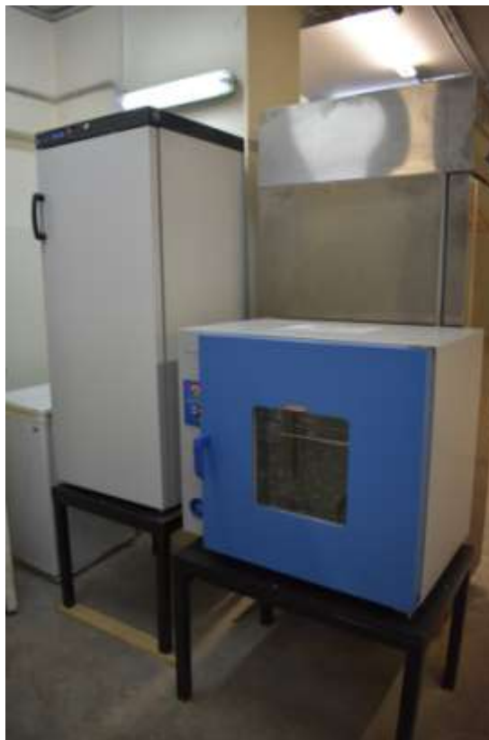
Εικ. 3.22 Θάλαμος ελεγχόμενων συνθηκών και κλίβανος απεντωμώσεων.
