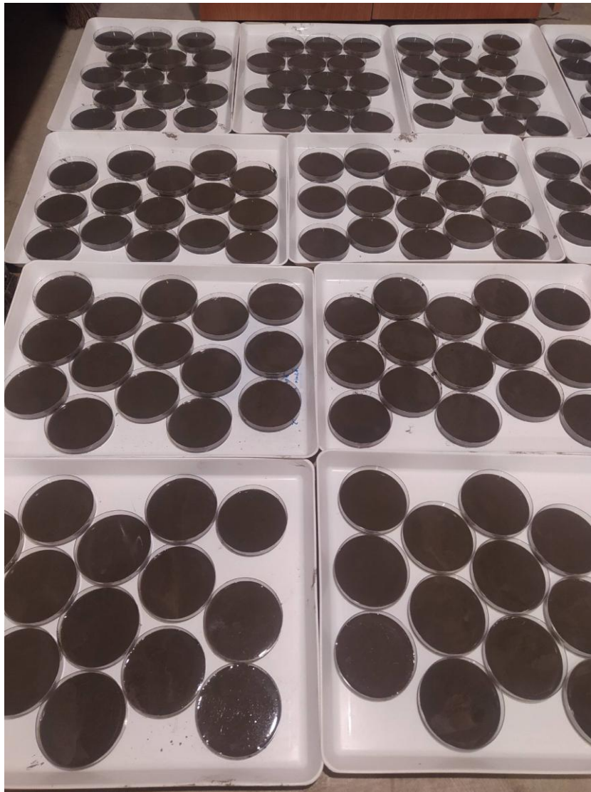
Εικ 2.19 Προσθήκη σκυροδέματος στα τρυβλία
