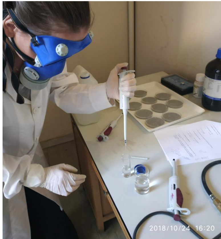
Εικ. 2.21 Παρασκευή εντομοκτόνου υδατικού διαλύματος προς εφαρμογή
