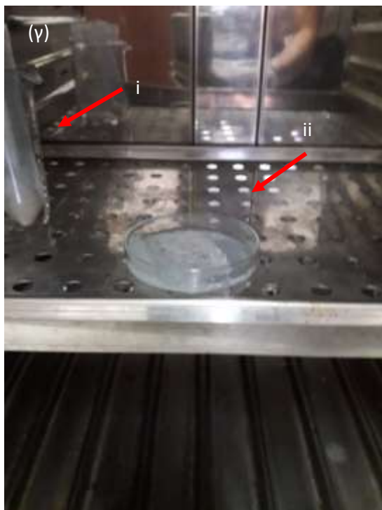
ΕΙΚΟΝΑ 14. Στάδια διαδικασίας προσδιορισμού διαλυτότητας, βαθμού διόγκωσης και ικανότητας κατακράτησης νερού. α) durax σε ελαιόλουτρο, β) durax σε ελαιόλουτρο, γ) i. ξήρανση ιζήματος σε φούρνο αέρος, ii. ξήρανση υπερκείμενου σε φούρνο αέρος και δ) ξήρανση του στρώματος της επιφάνειας του υπερκείμενου (Προσωπική συλλογή).
