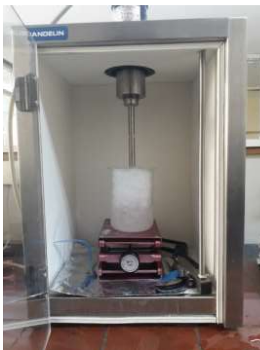
ΕΙΚΟΝΑ 15. Παραγωγή εναιωρήματος RSnp με χρήση υπέρηχων (Προσωπική συλλογή).
