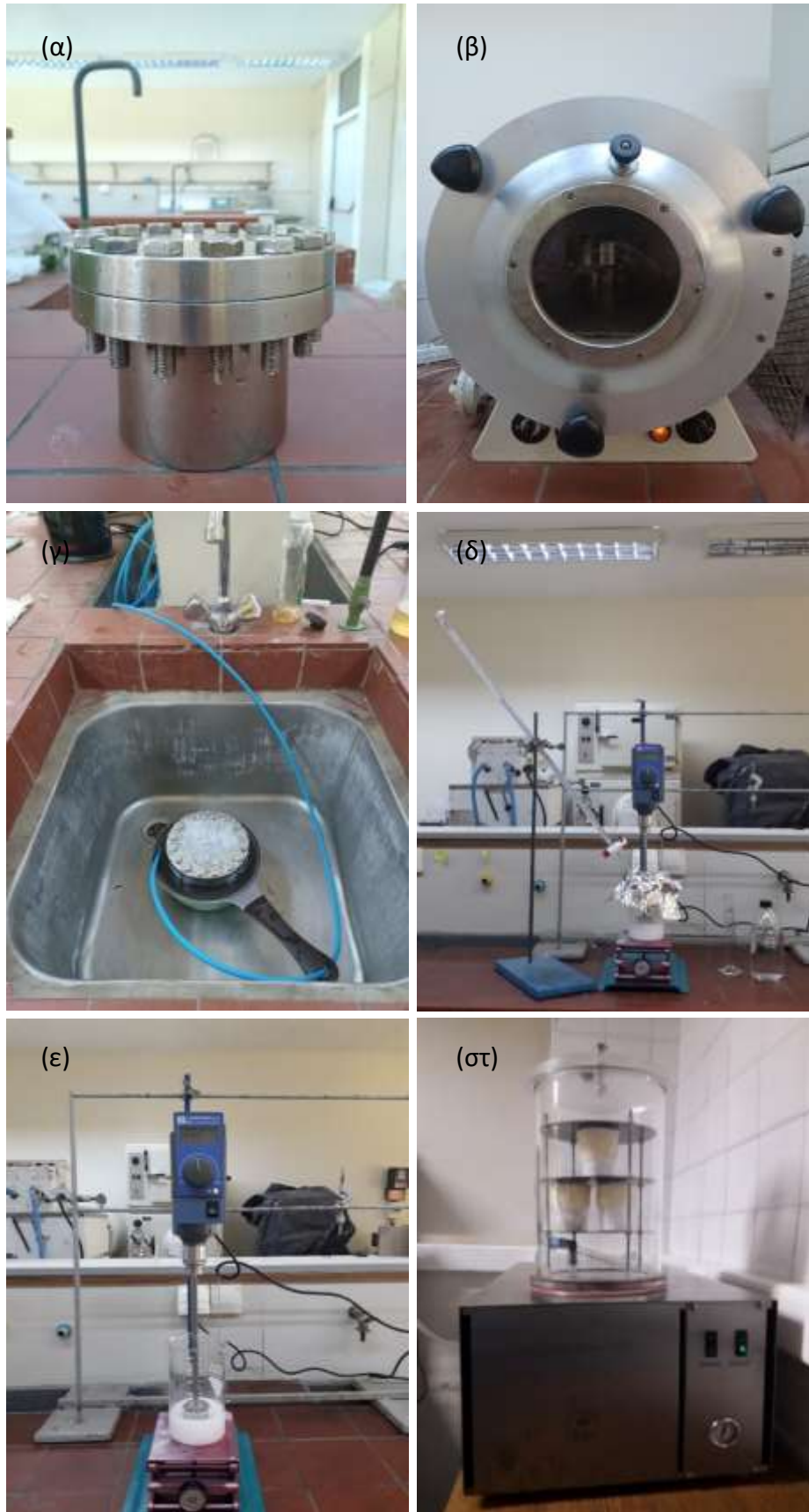
ΕΙΚΟΝΑ 12. Στάδια μεθόδου νανοκατακρήμνισης, α) αυτόκλειστο πριν την θέρμανση, β) αυτόκλειστο κατά την θέρμανση σε φούρνο αέρα, γ) παγόλυτρο, δ) προσθήκη αιθανόλης στο εναιώρημα με χρήση γυάλινης προχοϊδας, ε) ανάδευση μετά την προσθήκη αιθανόλης και στ) δείγματα στην λυοφιλοποίηση (Προσωπική συλλογή).
