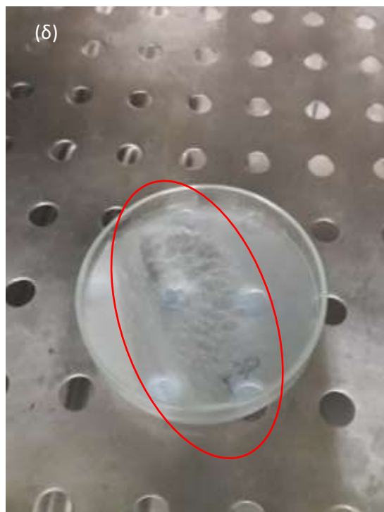
ΕΙΚΟΝΑ 14. Στάδια διαδικασίας προσδιορισμού διαλυτότητας, βαθμού διόγκωσης και ικανότητας κατακράτησης νερού. α) durax σε ελαιόλουτρο, β) durax σε ελαιόλουτρο, γ) i. ξήρανση ιζήματος σε φούρνο αέρος, ii. ξήρανση υπερκείμενου σε φούρνο αέρος και δ) ξήρανση του στρώματος της επιφάνειας του υπερκείμενου (Προσωπική συλλογή).
