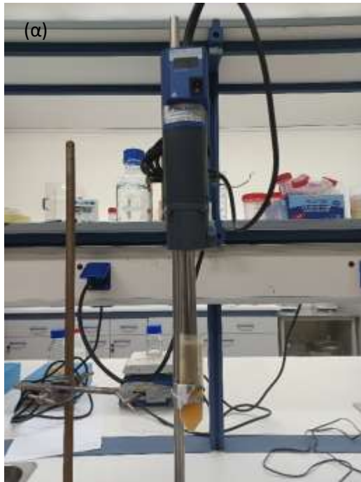
ΕΙΚΟΝΑ 17. Ομογενοποίηση γαλακτωμάτων με χρήση (α)TURRAX και (β) υπέρηχων (Προσωπική συλλογή).
