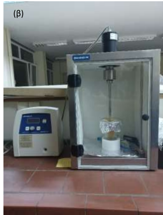
ΕΙΚΟΝΑ 17. Ομογενοποίηση γαλακτωμάτων με χρήση (α)TURRAX και (β) υπέρηχων (Προσωπική συλλογή).
