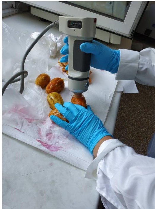
Εικόνα 20: Λήψη χρωματικών παραμέτρων L^* , a^* και b^* για τις σάρκες των καρπών.
