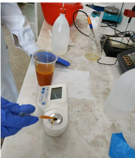
Εικόνα 30: Η τοποθέτηση των σταγόνων χυμού στο διαθλασίμετρο.
