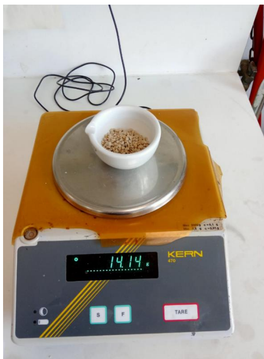
Εικόνα 27: Η ζύγιση του ξηρού βάρους των σπόρων.
