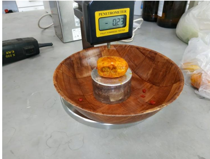
Εικόνα 19: Μέτρηση της δύναμης αντίστασης της σάρκας των καρπών.
