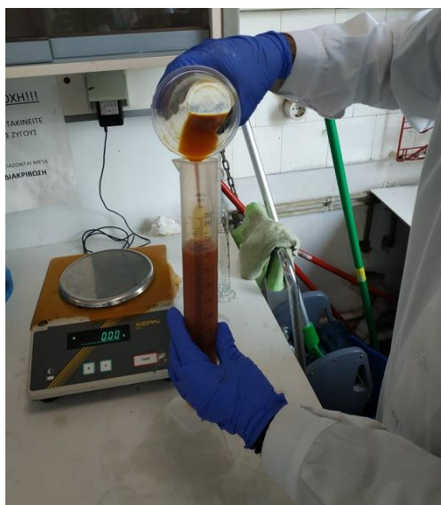
Εικόνα 29: Η μέτρηση του όγκου του χυμού με τη βοήθεια του ογκομετρικού σωλήνα.
