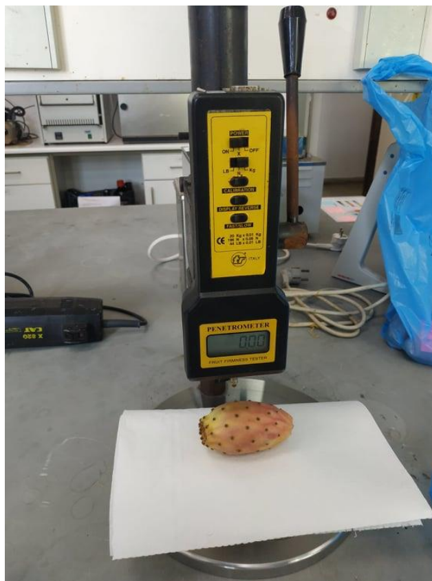
Εικόνα 14: Η διαδικασία μέτρησης της αντίστασης του καρπού με τη φλούδα του.
