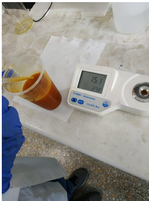
Εικόνα 31: Η ψηφιακή εξαγωγή των βαθμών °Brix του χυμού από το διαθλασίμετρο.
