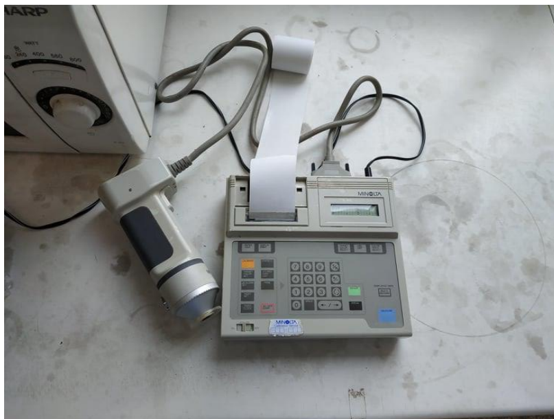
Εικόνα 16: Το χρωματόμετρο Minolta CR-300 το οποίο προσδιόρισε τις παραμέτρους L^* , a^* και b^* .
