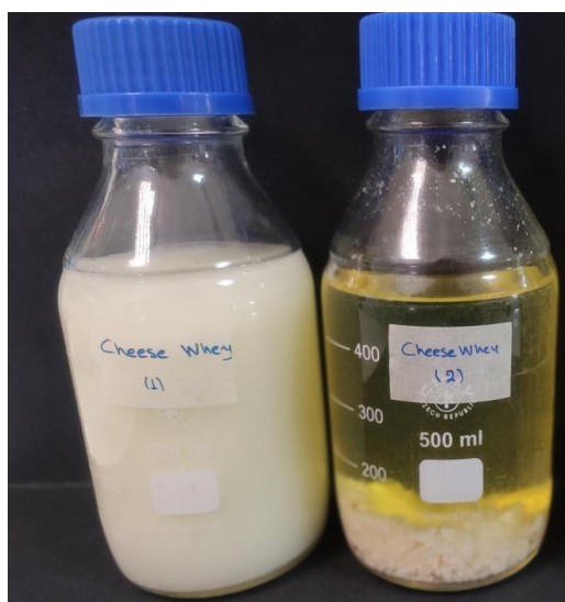
Εικόνα 6 Τυρόγαλα πριν και μετά την διαδικασία της αποπρωτεΐνωσης
