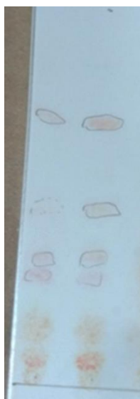
Εικόνα 12 Χρωματογράφημα TLC ακατέργαστων βιοεπιφανειοδραστικών από τα στελέχη CECT 278 και ACA-DC 183. Κινητή φάση \text{CHCl}_3 : \text{CH}_3\text{OH} : \text{CH}_3\text{COOH} : \text{H}_2\text{O} (25:15:4:2). Εμφάνιση χρωματογραφήματος με ψεκασμό με θειϊκή φαινόλη
