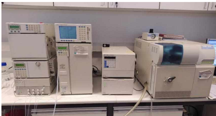
Εικόνα 3.5. Εργαστηριακή διάταξη του συστήματος LC-DAD/MS της SHIMADZU
