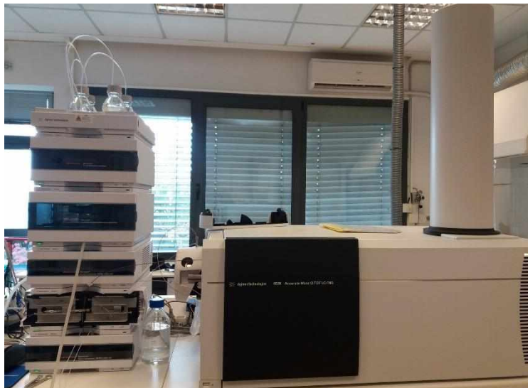
Εικόνα 3.10. Εργαστηριακή διάταξη αναλυτή χρόνου πτήσης ιόντων συνδυασμένου με τετράπολο.
