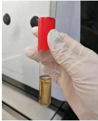
Εικόνα 9 Δοκιμαστικός σωλήνας με 5 mL TSB και επιφάνεια με επίστρωση διοξειδίου του τιτανίου στο οποίο έχει γίνει αρχική προσκόλληση των βακτηριακών κυττάρων έτοιμο για επώαση.
