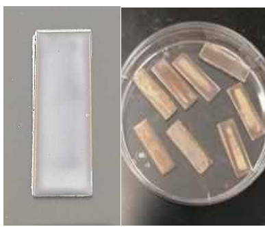
Εικόνα 7 Αριστερά επιφάνεια ανοξειδωτου χάλυβα με επίστρωση διοξειδίου του τιτανίου (TiO 2 ) και δεξιά επιφάνειες ανοξειδωτου χάλυβα με επίστρωση διοξειδίου του τιτανίου και ενσωματωμένα AgNPs.
