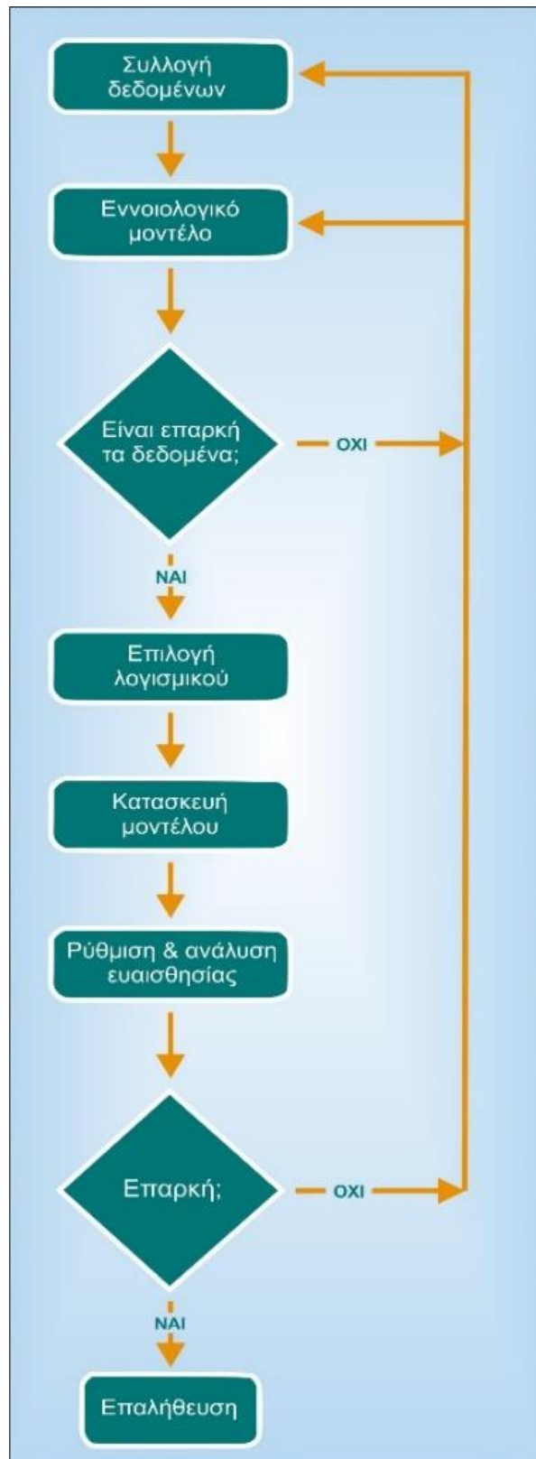
Εικόνα 13.1. Στάδια ανάπτυξης μοντέλου προσομοίωσης (ASTM D5447-93).
