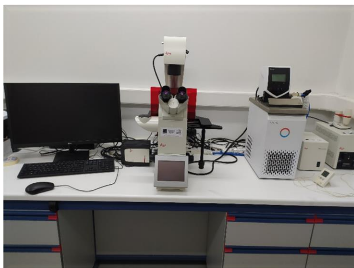
Εικόνα 4. Ανάστροφο Μικροσκόπιο Φθορισμού Leica DMi8 αντίθετης φάσης (phase contrast)
