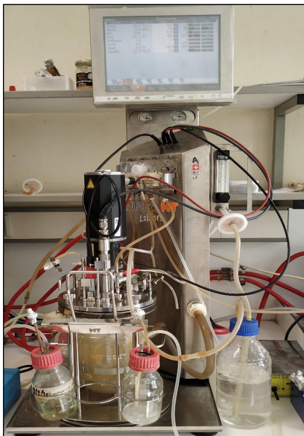
Εικόνα 16. Διάταξη ημι-συνεχούς ζύμωσης σε βιοαντιδραστήρα με στο βακτηριακό στέλεχος A. lata DSM 1123, σε υπόστρωμα αποβλήτων φρούτων [Εργαστήριο Μηχανικής & Επεξεργασίας Τροφίμων, ΓΠΑ].
