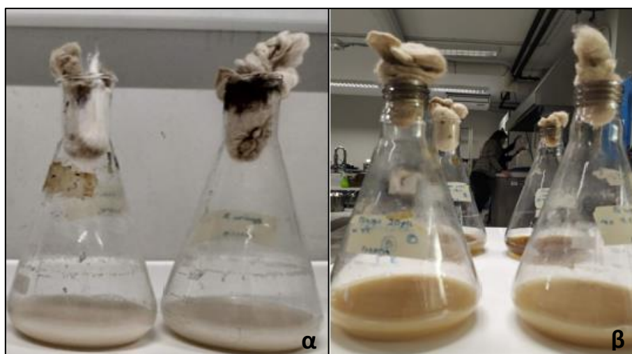
Εικόνα 15. Καλλιέργειες σε κωνικές φιάλες με το βακτηριακό στέλεχος A. lata DSM 1123 σε κωνικές φιάλες α. με πηγή άνθρακα την εμπορική σακχαρόζη και β. σε υπόστρωμα υδρολύματος πιτύρου σίτου [Εργαστήριο Μηχανικής & Επεξεργασίας Τροφίμων, ΓΠΑ].
