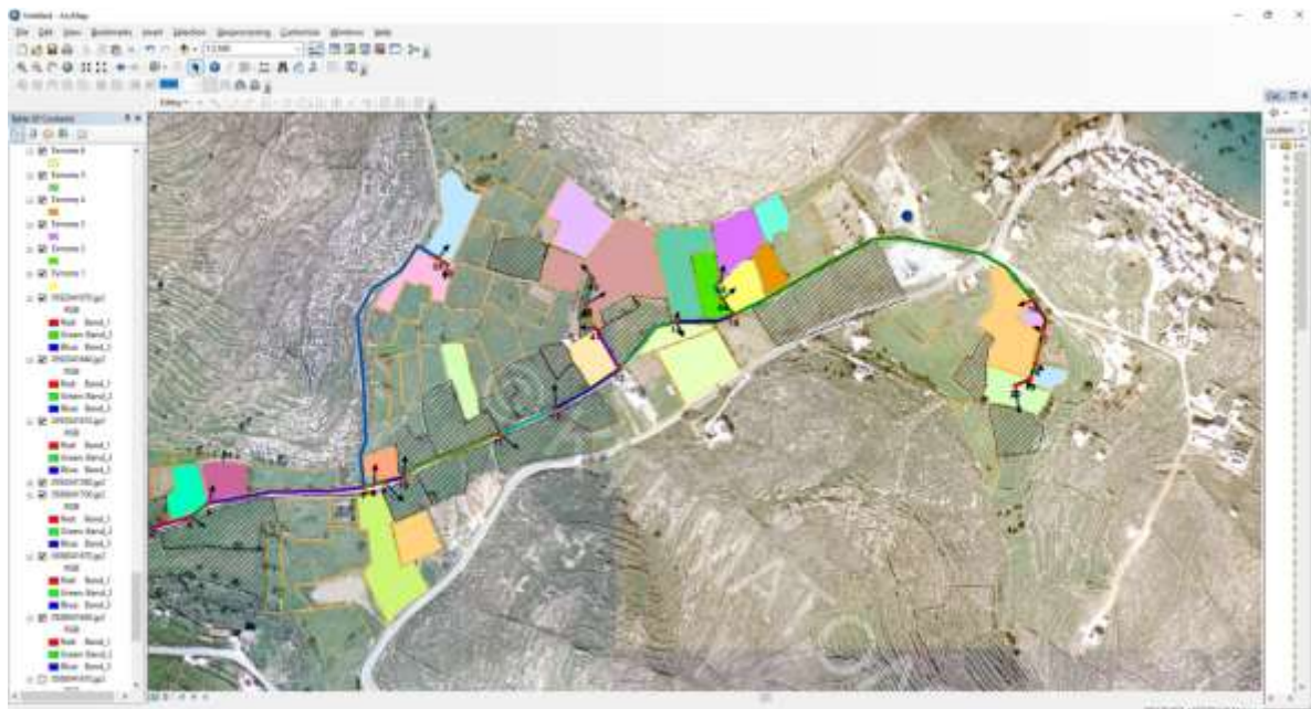
Εικόνα 5.22: Το τελικό δίκτυο με τις υδροληψίες (Ανατολικό Τμήμα), το σύστημα των αγωγών και τις αρδευτικές μονάδες σε σχέση με την περιοχή της μελέτης υπό κλίμακα εργασίας 1:2500.
