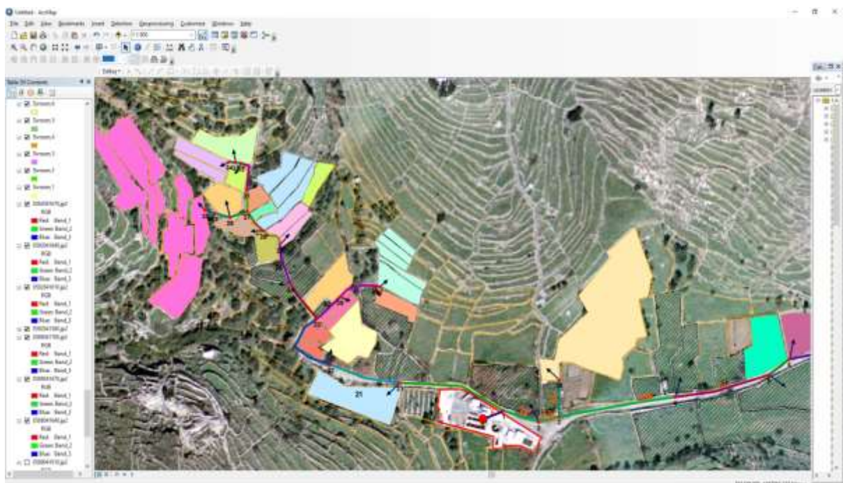
Εικόνα 5.23: Το τελικό δίκτυο με τις υδροληψίες (Δυτικό Τμήμα), το σύστημα των αγωγών και τις αρδευτικές μονάδες σε σχέση με την περιοχή της μελέτης υπό κλίμακα εργασίας 1:1500.
