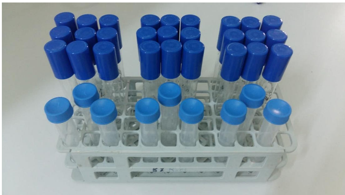
Εικόνα 7: Στατώ με falcon των 15 ml, τα οποία περιέχουν 6 ml PBS και 10 γυάλινα σφαιρίδια και οι αντίστοιχοι δοκιμαστικοί σωλήνες με 9 ml PBS για τις διαδοχικές δεκαδικές αραιώσεις.
