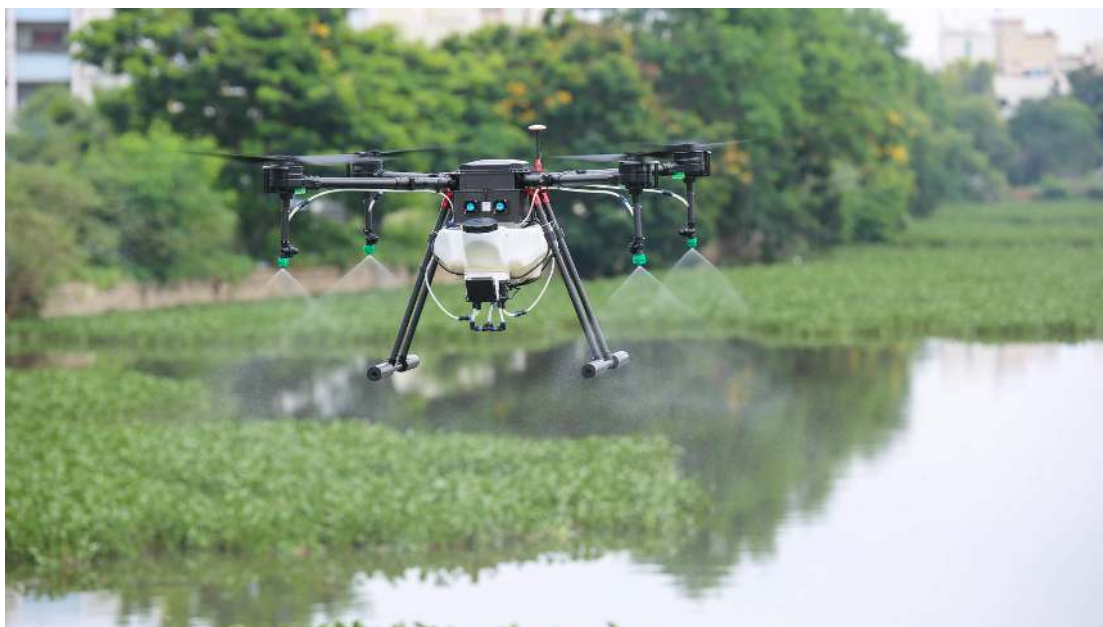
Εικόνα 1.19: Ψεκασμός υδάτινης επιφάνειας με drone
