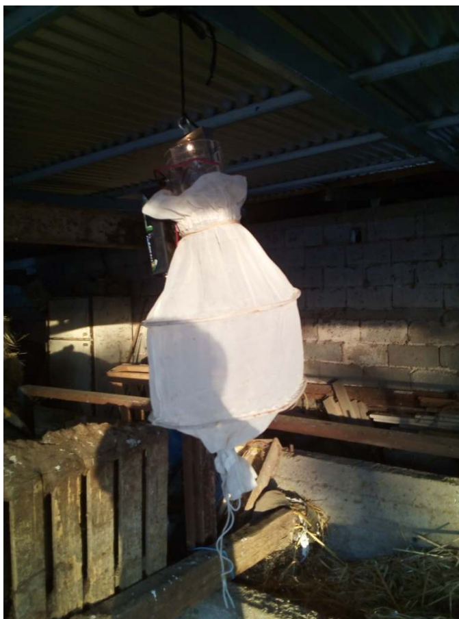
Εικόνα 4.2 Παγίδα CDC light trap σε στάβλο της περιοχής
