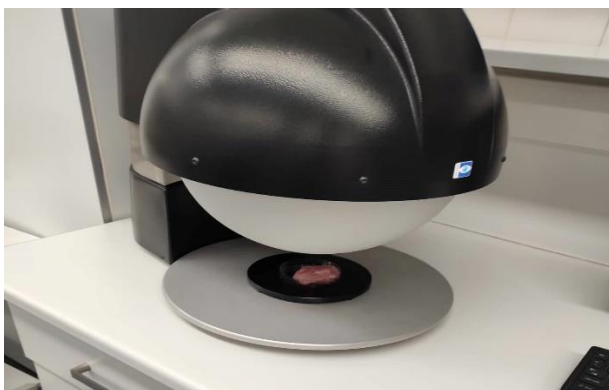
Εικόνες 2.7: Απεικόνιση του εσωτερικού της σφαίρας του VideometerLab (αριστερά) (Tsakanikas et al., 2015) και του εξωτερικού του (δεξιά).
