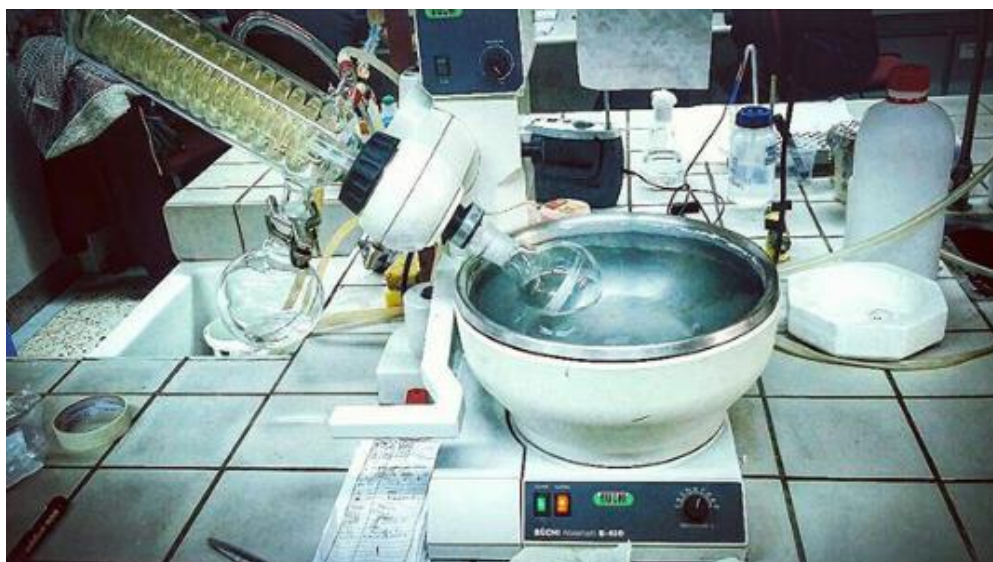
Εικόνα 11: Εξάτμιση του διηθήματος από την φιάλη εξάτμισης με τη βοήθεια περιστροφικού εξατμιστήρα (Flash Evaporator - Rotavapor R-114) υπό κενό.
