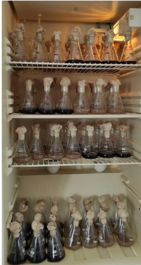
Εικόνα 11: Επώαση της καλλιέργειας σε θάλαμο θερμοκρασίας 26 \pm 1 °C υπό στατικές συνθήκες (Velp, model FOC 225E, Italy)
