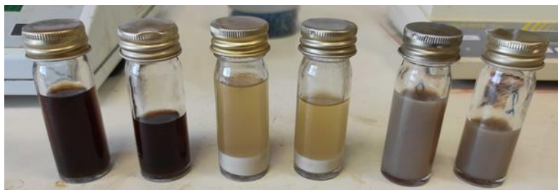
Εικόνα 10: Αρχικό θρεπτικό υπόστρωμα σε δοχείο mccartney α) 2 φιαλίδια υγρών ελαιουργικών αποβλήτων, β) 2 φιαλίδια κυτταρίνης, γ) 2 φιαλίδια ημικυτταρίνης.
