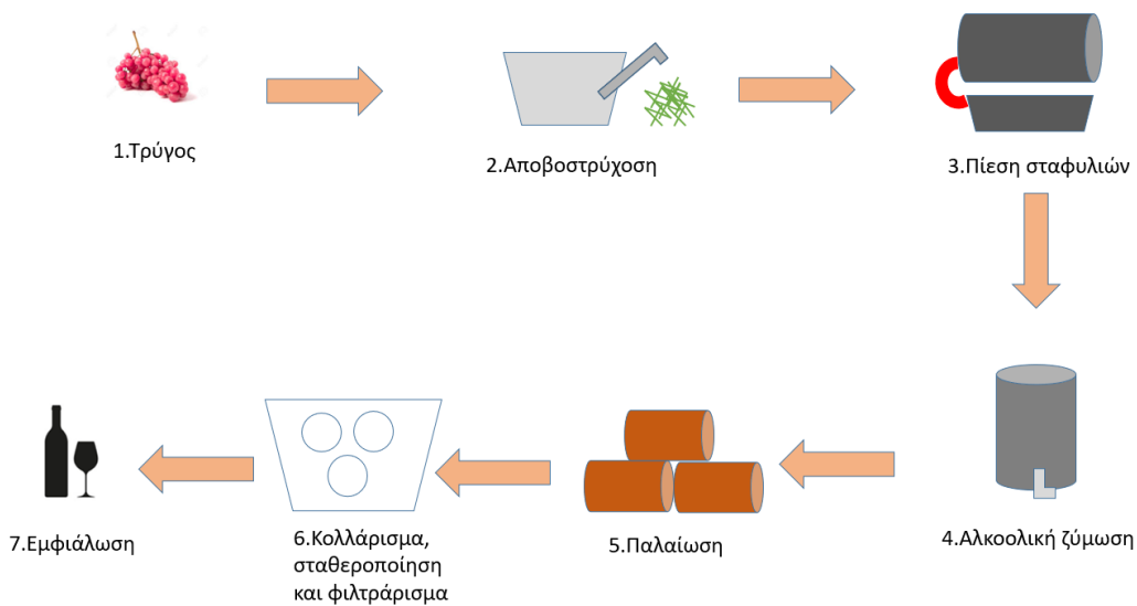
Σχήμα 1.1 Διάγραμμα παραγωγής ροζέ οίνων με εφαρμογή απευθείας πίεσης της σταφυλόμαζας έγχρωμων ποικιλιών
