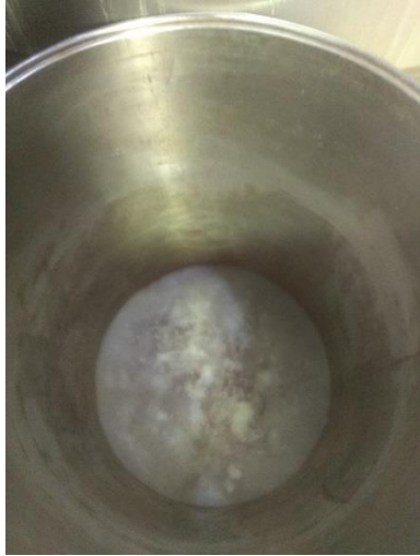
Εικ. 10. Προσθήκη ξηρού πάγου στην δεξαμενή απολάσπωσης για προστασία του γλεύκους από την οξείδωση
