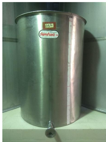
Εικ.. 9. Δεξαμενή απολάσπωσης
