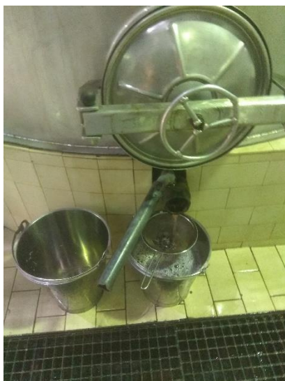
Εικ. 8. Παραλαβή έγχρωμου γλεύκους με αφαίμαξη
