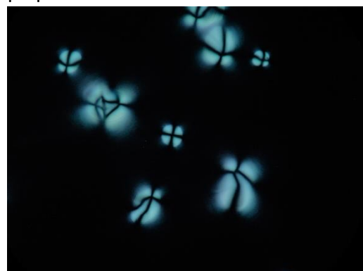
Εικόνα 35: Αμυλόκοκκοι Πατάτας υπό πολωμένο φως σε οπτικό μικροσκόπιο
