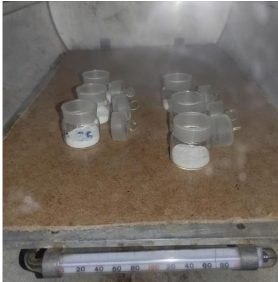
Εικόνα 15: Ξήρανση του αμύλου για την μέτρηση της υγρασίας.
