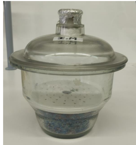
Εικόνα 16: Ξηραντήρας (desiccator) με αφυγραντικό μέσο P 2 O 5 .
