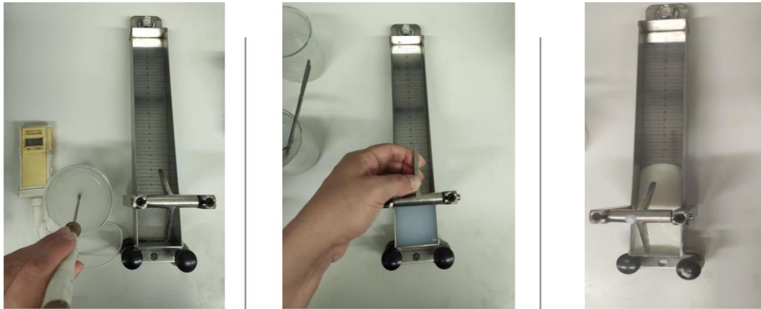
Εικόνα 24: Τα στάδια μέτρησης με τη συσκευή Bostwick
