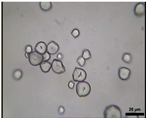
Εικόνα 31: Αμυλόκοκκοι από Κασσάβα σε οπτικό μικροσκόπιο
