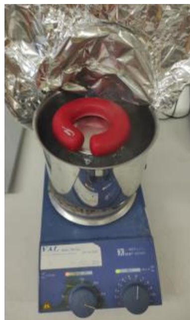
Εικόνα 18: Τοποθέτηση σε υδατόλουτρο (RCT Basic S1 Hot Plate Magnetic Stirrer, IKA)
