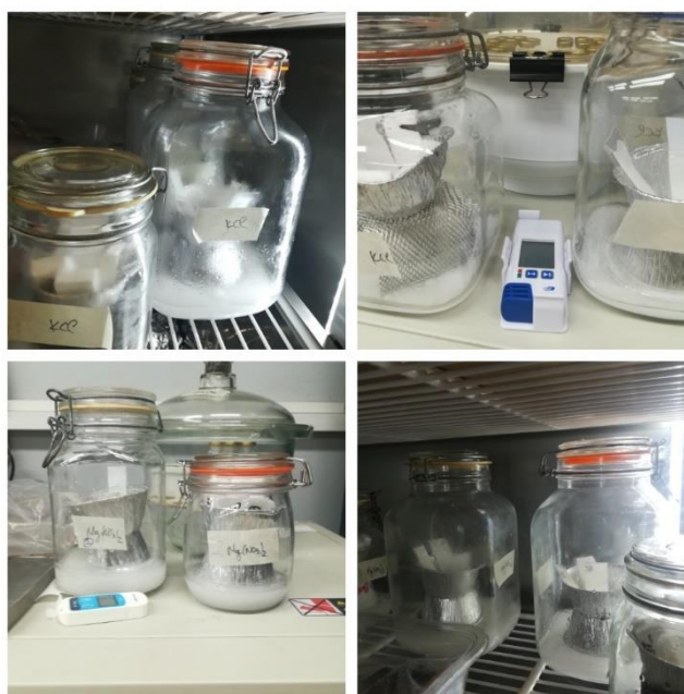
Σχήμα 21: Γυάλινα δοχεία σε διαφορετικές συνθήκες RH και \theta για μελέτη γήρανσης
