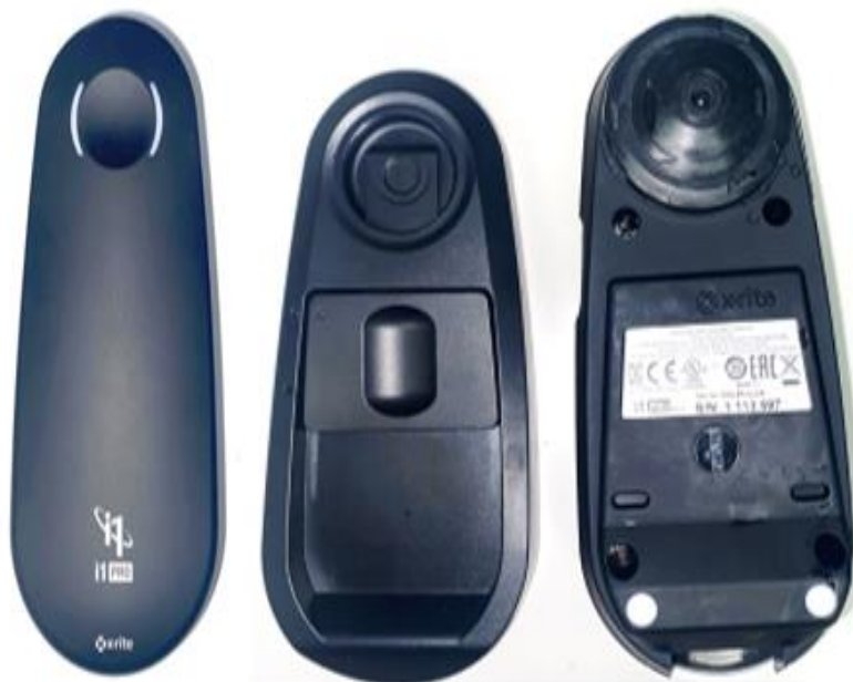
Εικόνα 3.4. Χρωματόμετρο Eye Pro 1, X-Rite, i1PRO REV E, 1 113 597 (X-Rite Asia Pacific Ltd., Hong Kong, China)
