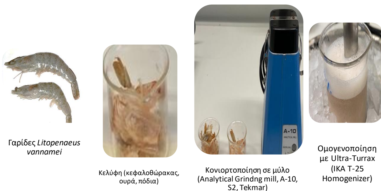
Εικόνα 3.8. Απεικόνιση της εκχύλισης της πολυφαινολοξειδάσης PPO (Πηγή: Προσωπικό αρχείο)
