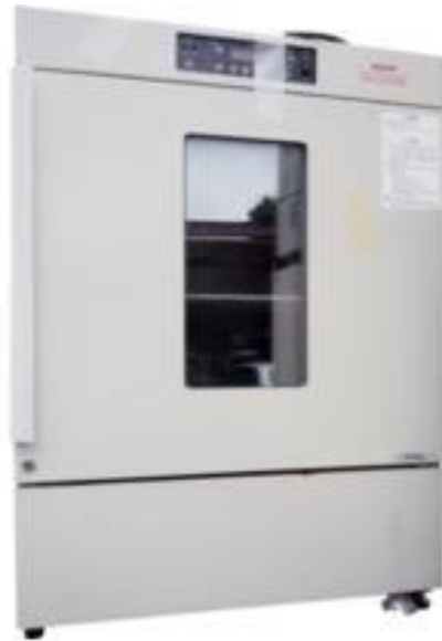
Εικόνα 3.3. Θερμοστατούμενος θάλαμος Sanyo MIR 153, Sanyo Electric, Ora-Gun, Gunma, Ιαπωνία (Πηγή: Προσωπικό αρχείο)
