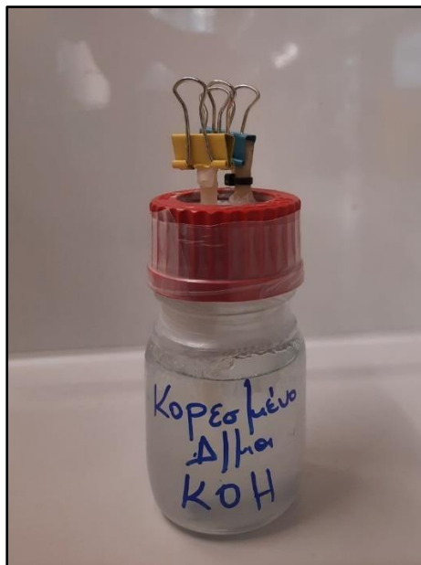
Εικόνα 7. Κορεσμένο διάλυμα καυστικού καλίου, προς προσδιορισμό της περιεκτικότητας του βιοαερίου σε μεθάνιο και διοξείδιο του άνθρακα (Εργαστήριο Μικροβιολογία και Βιοτεχνολογίας Τροφίμων, Γεωπονικό Πανεπιστήμιο Αθηνών).
