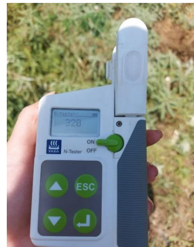
Εικόνα 3. 18: Μηχάνημα μέτρησης του SPAD (Προσωπικό αρχείο, ΓΠΑ 2022).
