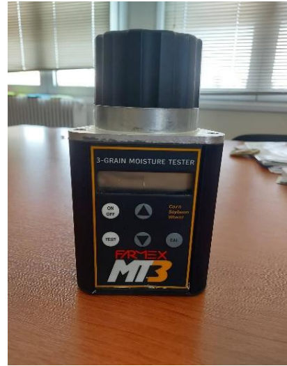
Εικόνα 3.17: Μηχάνημα μέτρησης υγρασίας Farmex MT3 φασολιού (Προσωπικό αρχείο, ΓΠΑ 2022).
