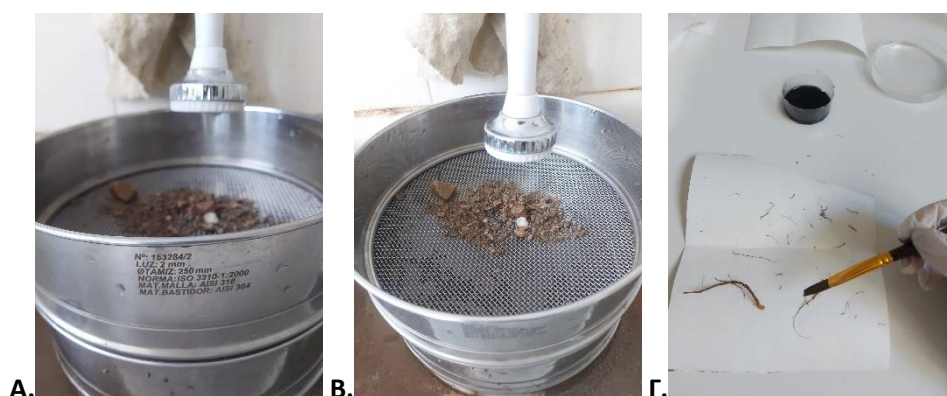
Εικόνα 3.20: Διαδικασία συλλογής ριζών. Α. Κόσκινο 0,2 mm, Β. Διαχωρισμός με την βοήθεια τρεχούμενου νερού, Γ. Χρωματισμός των ριζών με σινική μελάνη, (Προσωπικό αρχείο, ΓΠΑ 2022).
