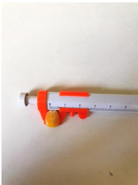
Εικόνα 40. Μέτρηση του πλάτους του σπόρου
