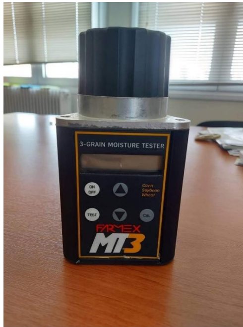
Εικόνα 33. Φορητό υγρασιόμετρο σπόρων Farmex MT3
