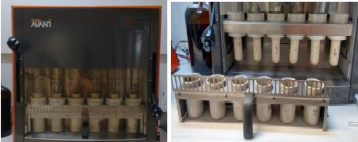
Εικόνα 10: Συσκευή εκχύλισης Soxhlet (SOXTEC AVANTI 2055) , φυσίγγια κυτταρίνης και ποτήρια αλουμινίου τοποθετημένα σε στατό.
