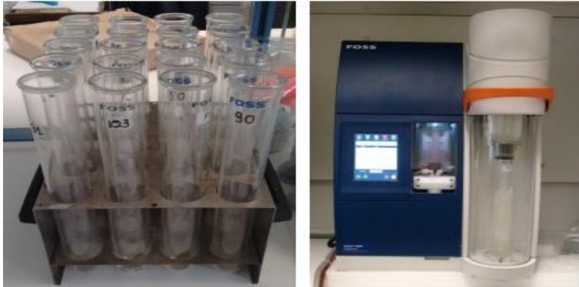
Εικόνα 11: Αριστερά οι κάψες ή σωλήνες Kjeldahl όπου τοποθετείται το δείγμα προς ανάλυση και δεξιά η συσκευή Foss – Kjeltec 8400.
