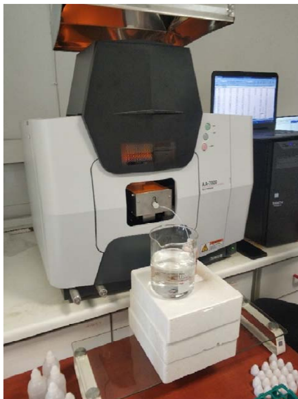
Εικόνα 13. Τα φλογοφωτόμετρα που χρησιμοποιήθηκαν για τον προσδιορισμό της συγκέντρωσης K^+ , Na^+ , Ca^{2+} , Mg^{2+} και P^{2+} στα δείγματα.
