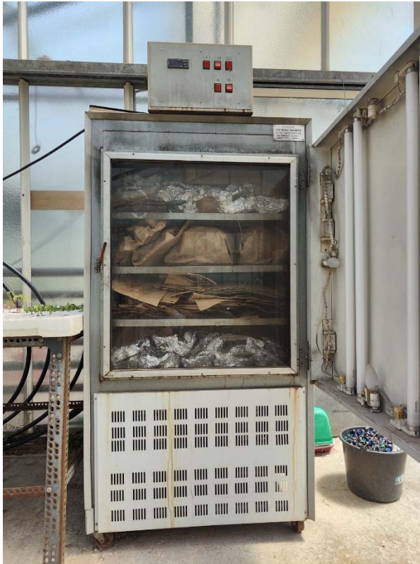
Εικόνα 10. Το ξηραντήριο και ο μύλος που χρησιμοποιήθηκαν για την αποξήρανση και την άλεση των φυτικών ιστών.
