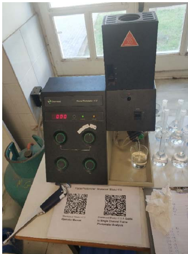
Εικόνα 13. Τα φλογοφωτόμετρα που χρησιμοποιήθηκαν για τον προσδιορισμό της συγκέντρωσης K^+ , Na^+ , Ca^{2+} , Mg^{2+} και P^{2+} στα δείγματα.
