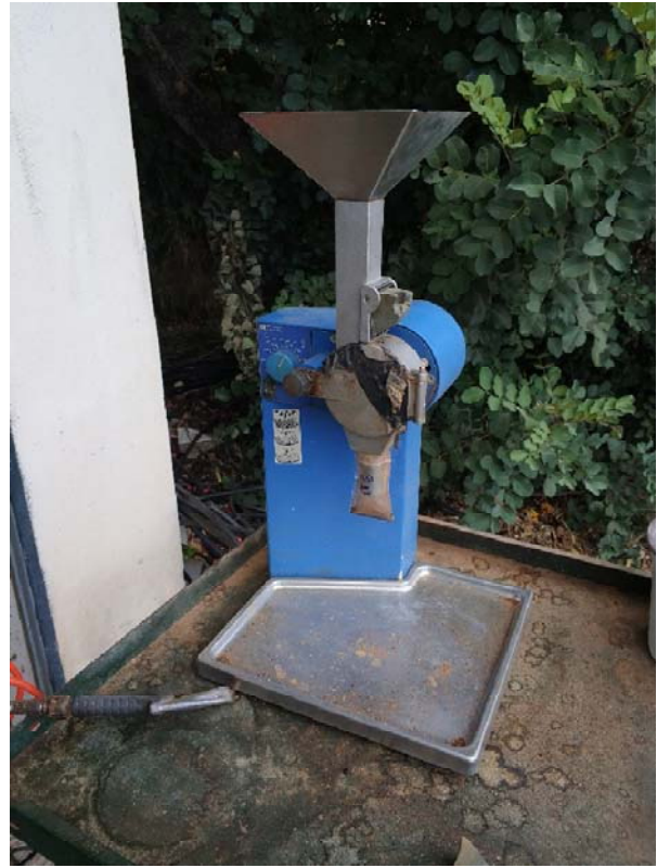
Εικόνα 10. Το ξηραντήριο και ο μύλος που χρησιμοποιήθηκαν για την αποξήρανση και την άλεση των φυτικών ιστών.
