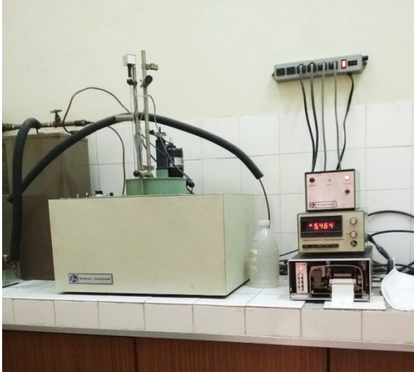
Εικόνα Β.4: Αδιαβατικό θερμιδόμετρο
