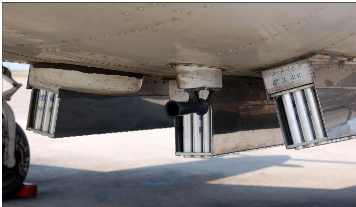
Εικόνα 7: Εκτοξευόμενα φυσιίγια των 20gr υλικού σποράς (Πηγή : ΚΕΜΕ ΕΛ.Γ.Α.)
