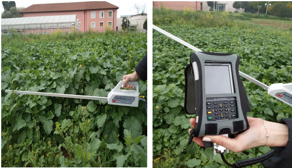
Εικόνες 10,11: Μηχάνημα για την μέτρηση του Leaf Area Index (LAI), Sun Scan type SSI (Delta-T Devices Cambridge- England). (Προσωπικό αρχείο)
