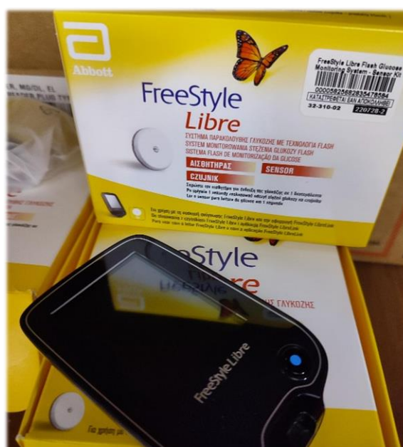
Εικόνα 4.3: Αισθητήρας συνεχούς καταγραφής γλυκόζης (CGM) και μηχανήμα ανάγνωσης Free Style Libre, Abbott Laboratories
