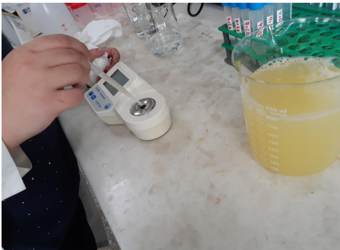
Εικόνα 20 Μέτρηση ολικών διαλυτών στερεών χυμού με ψηφιακό διαθλασίμετρο
