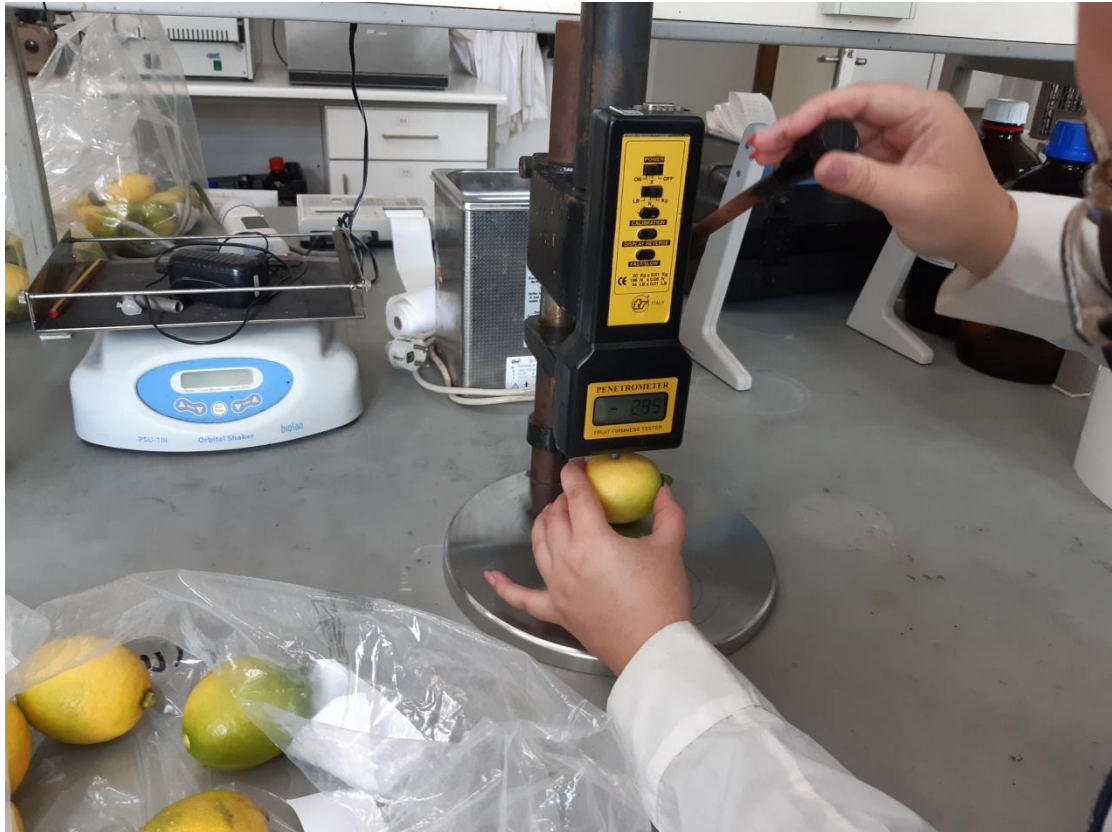
Εικόνα 16 Μέτρηση συνεκτικότητας φλοιού με το πενετόμετρο
