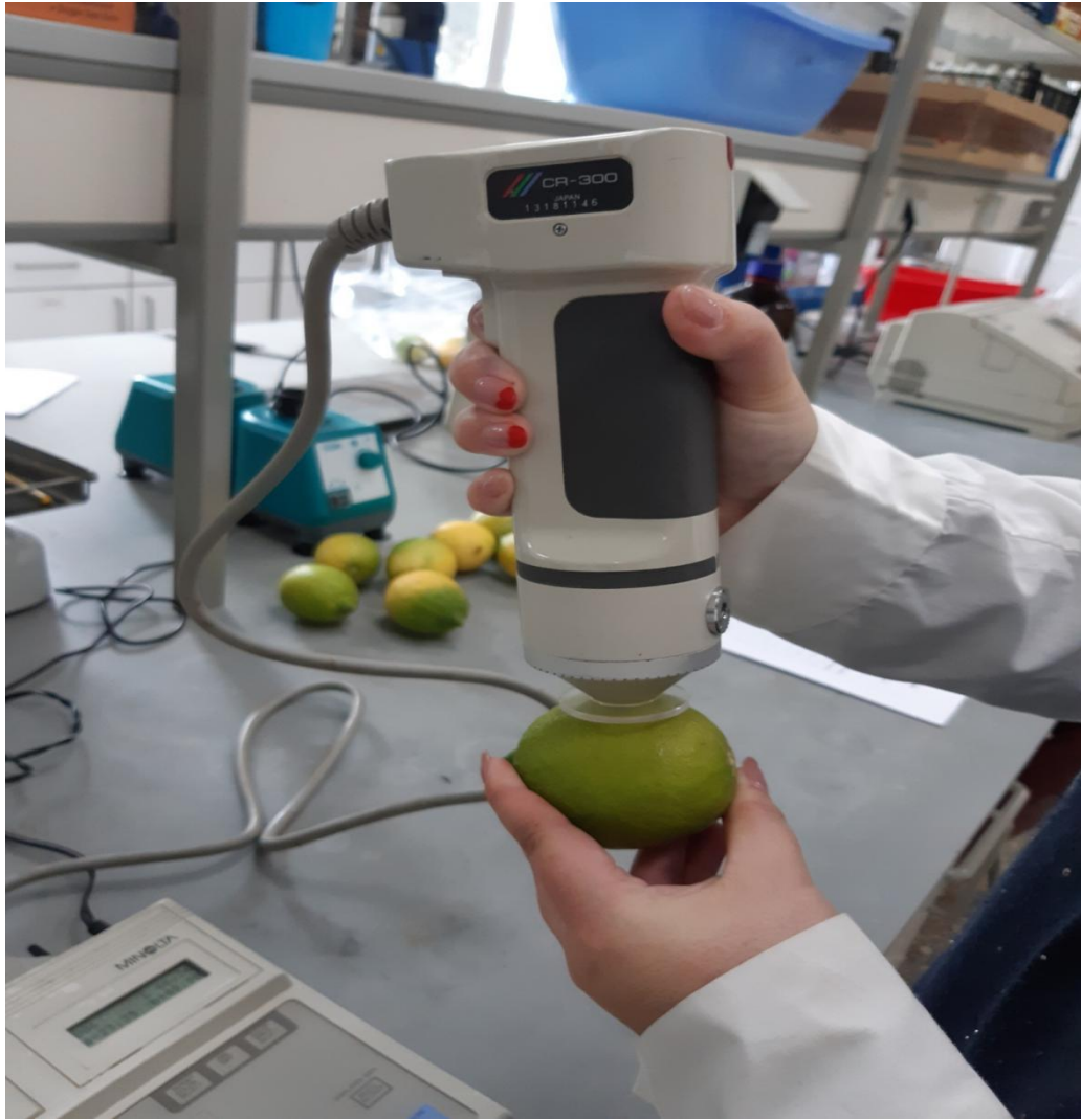
Εικόνα 17 Μέτρηση χρώματος φλοιού των καρπών με το ψηφιακό αυτόματο χρωματόμετρο
