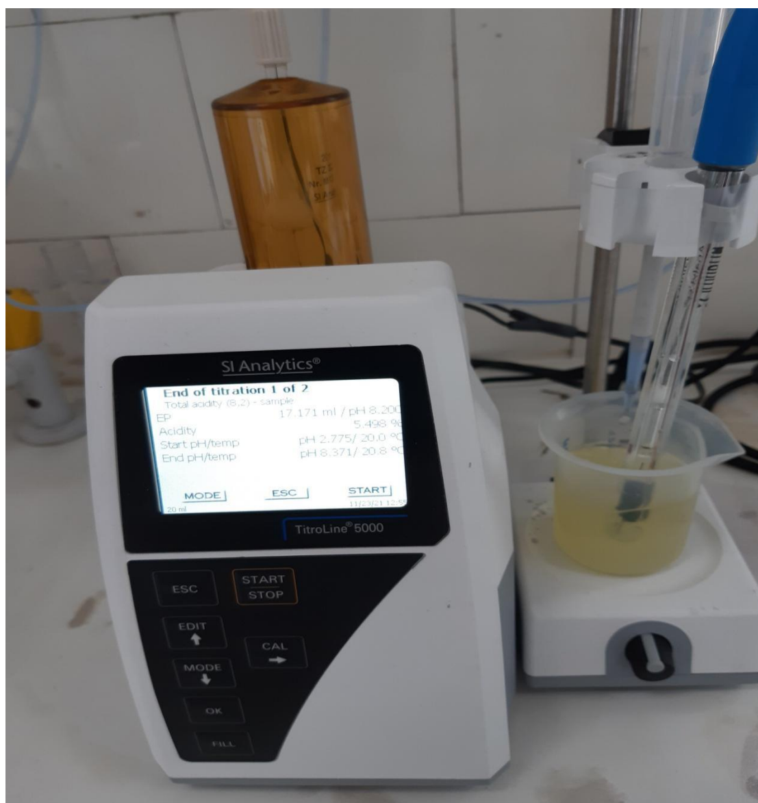
Εικόνα 21 Μέτρηση ολικής ογκομετρούμενης οξύτητας χυμού
