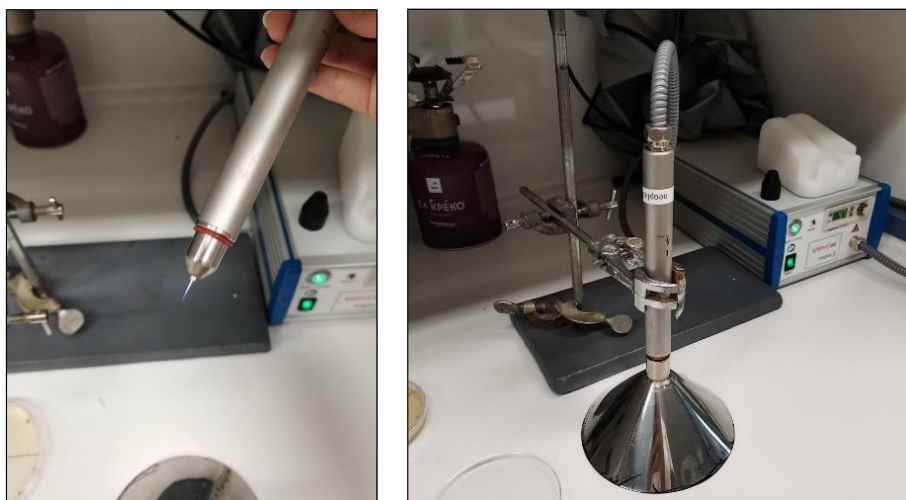
Εικόνα 4.4: Η συσκευή παραγωγής ψυχρού πλάσματος (kINPen IND model). Αριστερά το εξάρτημα τύπου στυλό με το χαρακτηριστικό «λοφίο» και δεξιά η συσκευή σε λειτουργία με χρήση κωνικής απόληξης.
