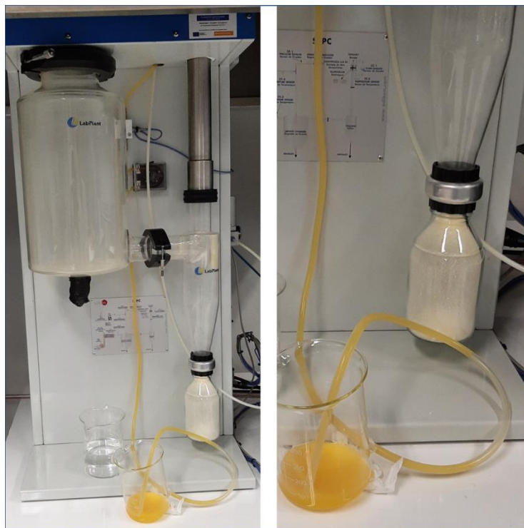
Σχήμα 12. Ξηραντήρας ψεκάσμου Edibon Sray dryer (αριστερά), αντλία τροφοδοσίας και δοχείο συλλογής (δεξιά).
