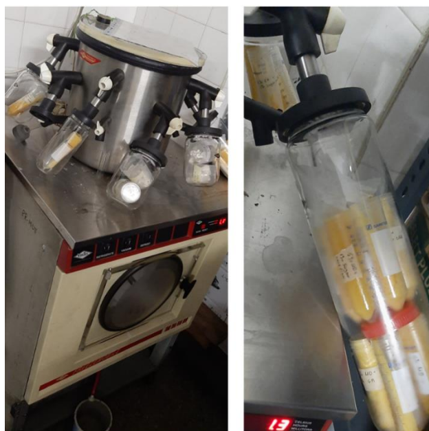
Σχήμα 13. Ξηραντήρας Virtis Freezemobile, (αριστερά), δείγματα για ξήρανση (δεξιά).
