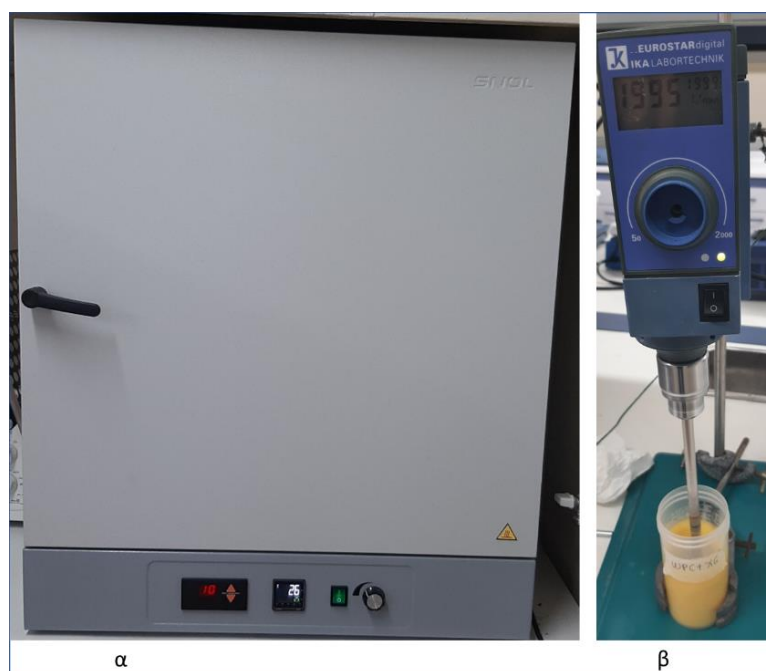
Σχήμα 14. Φούρνος SNOL (α) και ηλεκτρονικός αναδευτήρας EUROSTAR (β).
