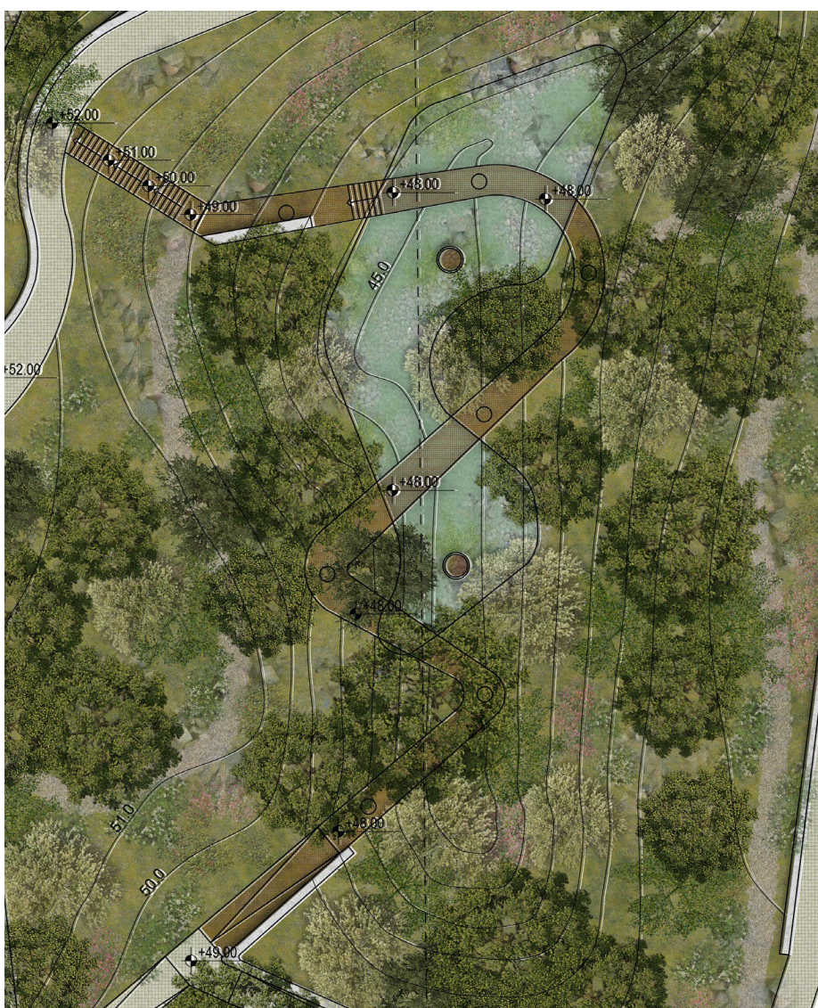
54. Μεταλλική γέφυρα πάνω από λεκάνη κατάκλισης
