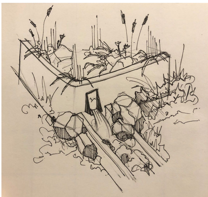
47. Σκίτσο σύνδεσης αντιπλημμυρικού ταμιευτήρα με κανάλι υπερχείλισης
