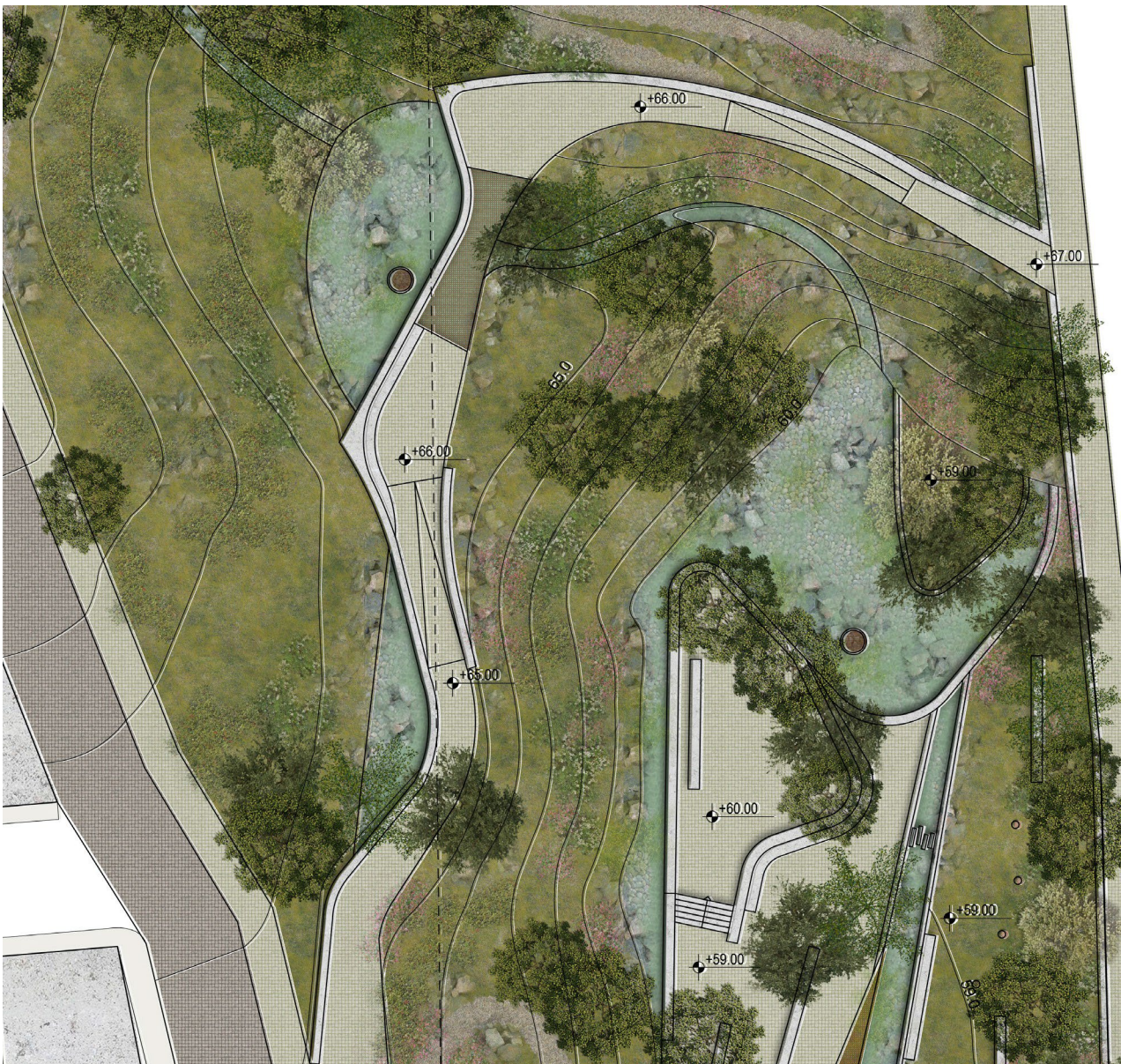
49. Αντιπλημμυρικός ταμιευτήρας και κανάλι υπερχείλισης
