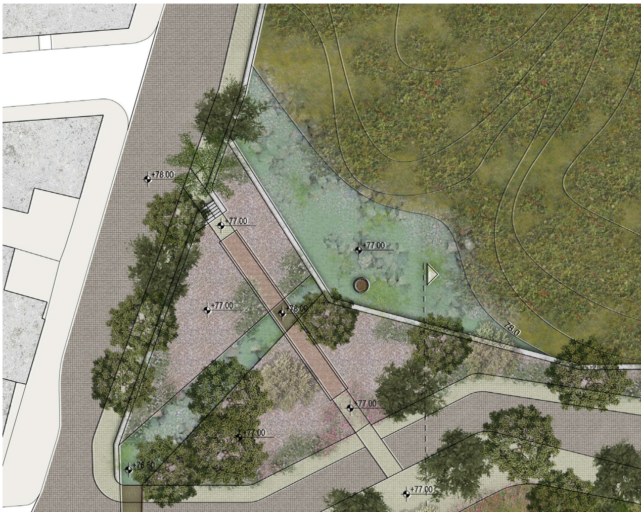
46. Αντιπλημμυρικός ταμιευτήρας και κανάλι υπερχείλισης
