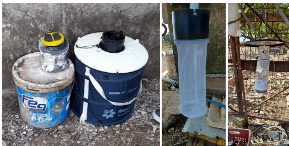
Εικόνα 3.6: Οι παγίδες που χρησιμοποιήθηκαν για τη συλλογή ενηλίκων ατόμων (από αριστερά προς τα δεξιά: τύπου BG sentinel, CDC light trap και EVS trap) (Λήψεις: Κολιόπουλος Γεώργιος, Παρνασσά Βλασία)
