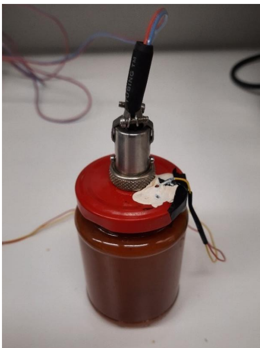
Σχήμα 13b. Γυάλινος περιέκτης τοματοχυμού με τοποθετημένα θερμοστοιχεία σε κέντρο και καπάκι.
