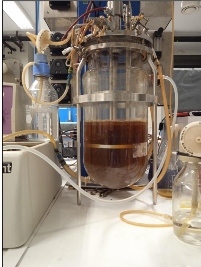
Εικόνα 10. Ημι-συνεχής ζύμωση σε βιοαντιδραστήρα Bioengineering, RALF Advanced 6.7 L
