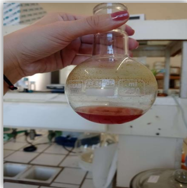
Εικόνα 16 Δείγμα φαινολικών συστατικών μετά την λήξη λειτουργίας περιστρεφόμενου συμπυκνωτήρα
