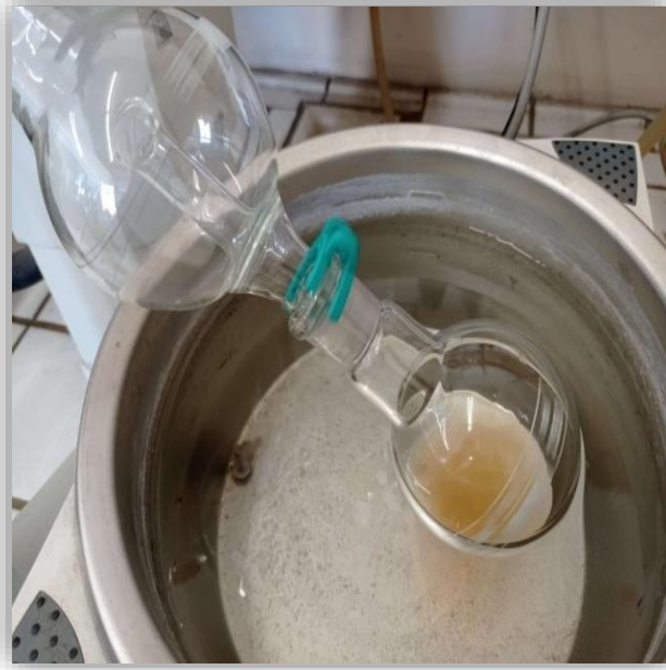
Εικόνα 15 Δείγμα φαινολικών συστατικών πριν την έναρξη λειτουργίας του περιστρεφόμενου συμπυκνωτήρα
