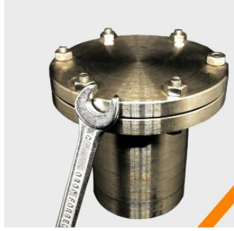
Σχήμα 15: Αυτόκλειστος αντιδραστήρας με γεωμετρία "βόμβας".
