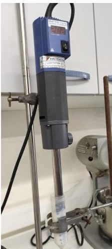
Σχήμα 10: Αναδευτήρας, IKA T 25 digital ULTRA-TURRAX®, Germany.
