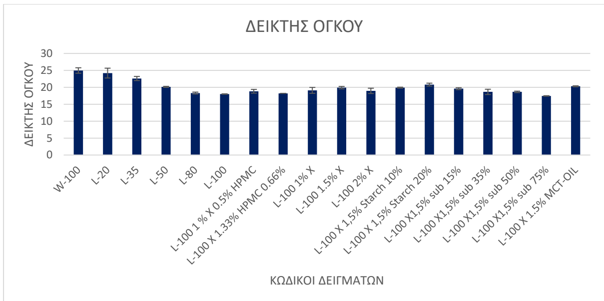
Σχήμα 33: Συνολική απεικόνιση όλων των δειγμάτων, ως προς τη μέτρηση του δείκτη όγκου.
