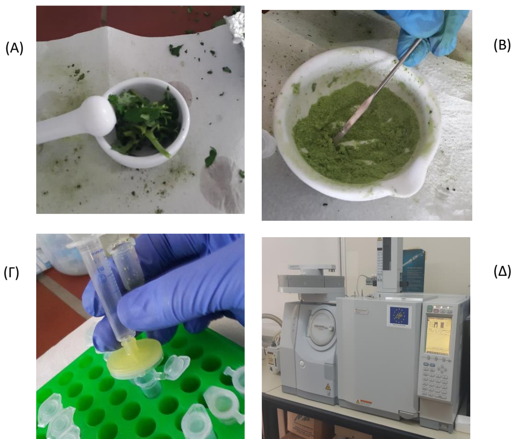
Εικόνα 3-6. Χειρισμός των δειγμάτων μεταβολομικής. Α,Β: λειοτριβήση δειγμάτων με την ταυτόχρονη εφαρμογή υγρού αζώτου. Γ: διήθηση με τη χρήση φίλτρου PTFE. Δ: αέριος χρωματογράφος.
