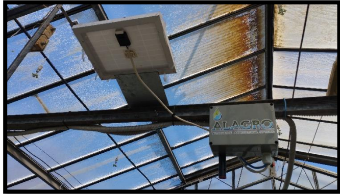
Εικόνα 3-3. Ηλιόμετρο εγκατεστημένο εντός του θαλάμου του θερμοκηπίου για την ρύθμιση των κύκλων χορήγησης του θρεπτικού διαλύματος στην καλλιέργεια.
