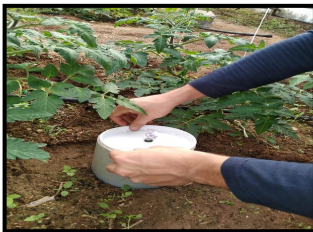
Εικόνα 4-7. Συλλογή αερίων θερμοκηπίου από το έδαφος του θερμοκηπίου με ειδικές συσκευές «chambers».
