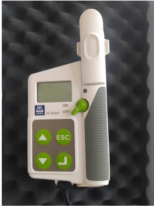
Εικόνα 15: Συσκευή μέτρησης συγκέντρωσης χλωροφύλλης (Πηγή: Προσωπικό αρχείο)
