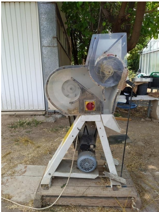
Εικόνα 19: Πνευματική μηχανή καθαρισμού σπόρων (Πηγή: Προσωπικό αρχείο)
