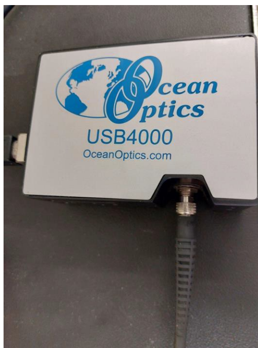
Εικόνα 32: Φασματόμετρο της εταιρείας Ocean Optics που διαθέτουμε στο εργαστήριό μας και χρησιμοποιήθηκε για τη λήψη των φασμάτων.
