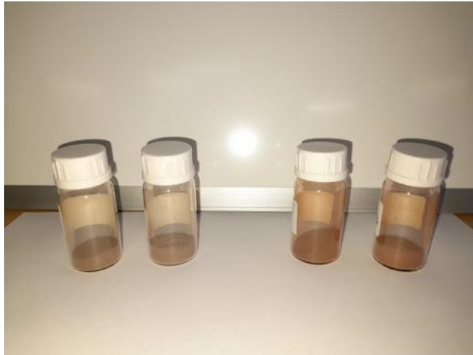
Εικόνα 15.: Αριστερά μιμητικός Σεληνιακός ρεγόλιθος, δεξιά μιμητικό αρειανό χόμα (Stavrakakis et al., 2022).
