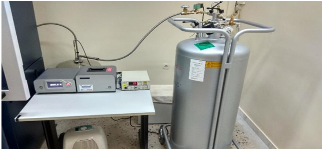
Εικόνα 2.4: Απεικόνιση των τμημάτων του περιθλασίμετρου D8 Venture της Bruker, με τον την πηγή των ακτίνων (1), τη συσκευή παροχής ρεύματος αζώτου (2), τον ανιχνευτή PHOTON 50 (3), την ειδική παγίδα
