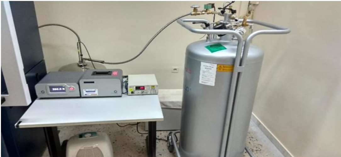
Εικόνα 2.4: Απεικόνιση των τμημάτων του περιθλασίμετρου D8 Venture της Bruker, με τον ανιχνευτή PHOTON 50 και (B) η συσκευή Cryostream 800series της Oxford CryoSystems
